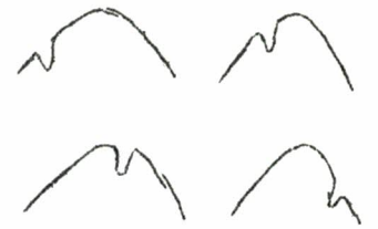
FIGUUR 2b. Hieruit blijkt, hoe de plaats van de onderdrukkingspiek over de hele bandbreedtekromme van de m.f.versterker kan wandelen, door afstemming van de kring van het filter. De bandbreedte blijft, in tegenstelling tot het x-tal filter, constant.
