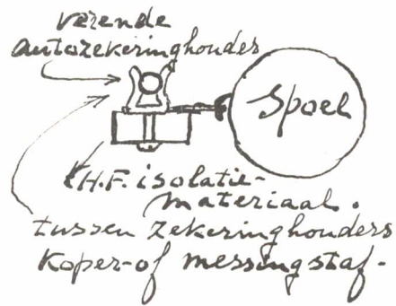
FIG. 3 schuivende kortsluit- inzichting voor Tankspoel. naar "HINTS and KINKS" A.R.R.L.
