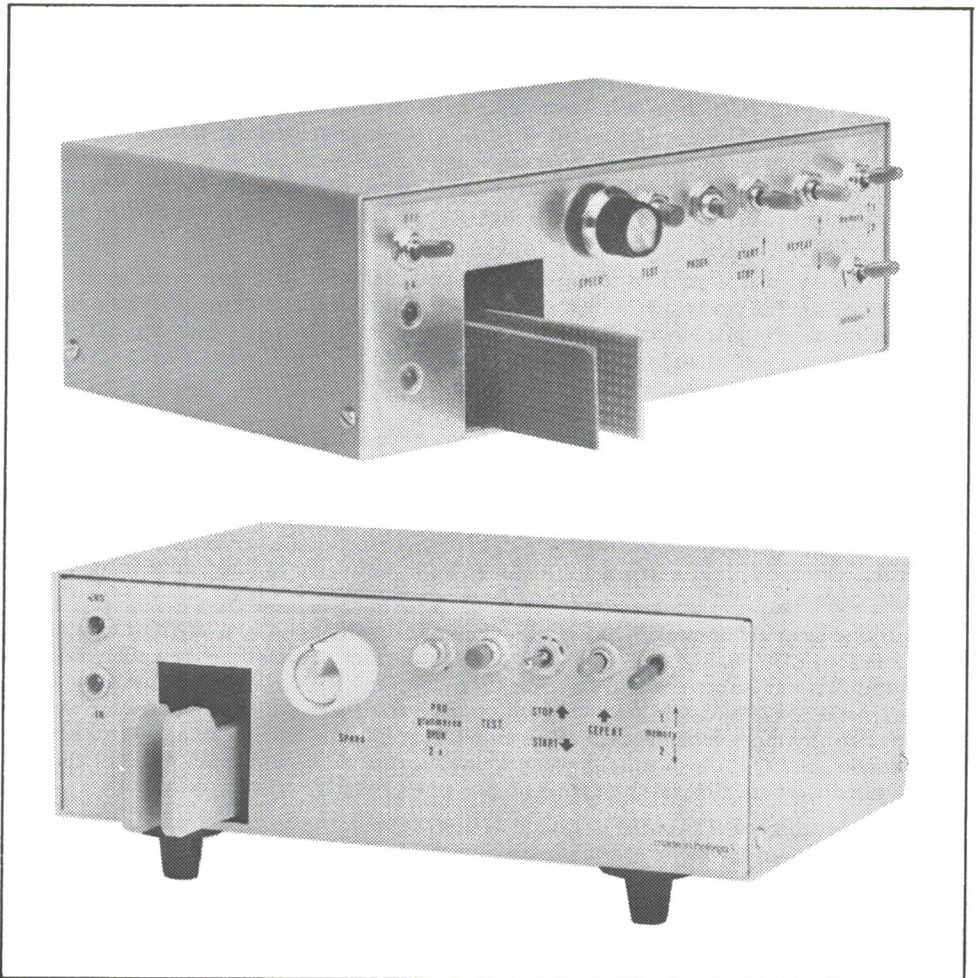
Twee uitvoeringen van de memory-keyer. Bij de bovenste uitvoering werd gebruik gemaakt van een home-made paddle terwijl in de onderste een fabrieks paddle werd toegepast. Beide uitvoeringen worden in dit artikel beschreven!
