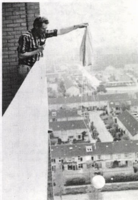
Foto linksboven: De PAoMUS-zender in twee halve tempex bollen. Rechtsboven: Ook in het water moet de zender blijven werken. Linksonder: Van 50 meter hoogte naar beneden. Rechtsonder: Daalsnelheid 3 meter/sec.; dat overleeft de zender wel.
