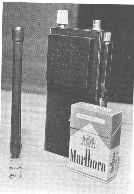
FOTO 1. Het fraaie kastje gemaakt van dubbelzijdig epoxy-printplaat.
