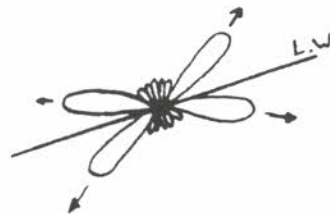
FIGUUR 1 Stralingsdiagram met hoofd-lobben
