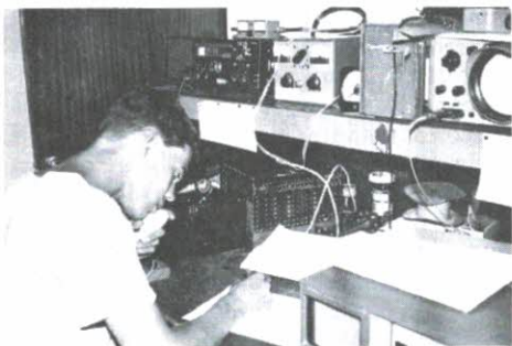
3D6CW in actie: FT250 + zelfbouw ATV past 300Ω lintlijn aan op 50Ω
