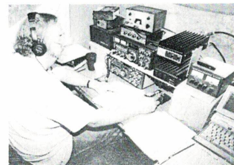
Ned Stearns, AA7A operator van K7TR Velddagstation zorgde voor een totaal van 377 punten. FT-726R was de belangrijkste satellietradio. Automatisch antenne volgen werd gedaan met SASI SAT TRACKER en een oude Laptop computer. Zijn antennes waren enkele CP yagi's van 2 en 70, een SB-32 voor mode S en CP loop voor 10 meter en 3 el yagi van 15 meter. Gewerkt werd via RS-10, RS-12, AO-10, AO-13, FO-20, AO-21 en AO-27. (Photo by W1XT).
