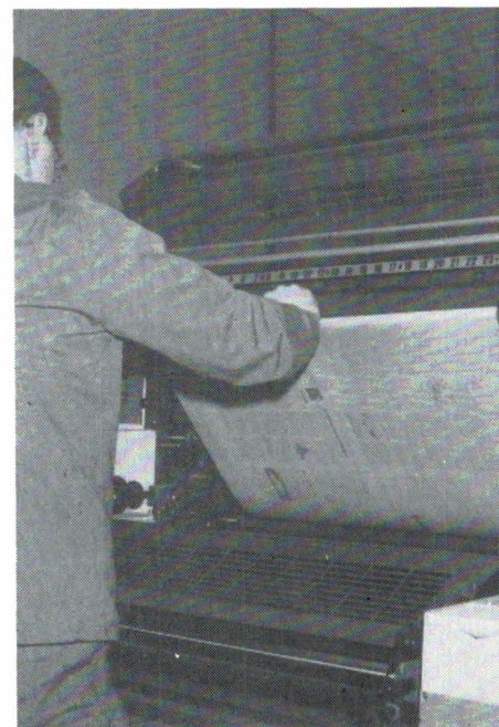
De ontwikkelde offset-plaat wordt op de trommel in de drukpers gemonteerd...
