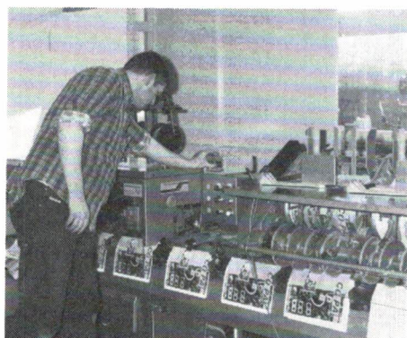
Andries Snippe stelt de machine, waarin omslag en katerns samengevoegd en geniet worden, af.
