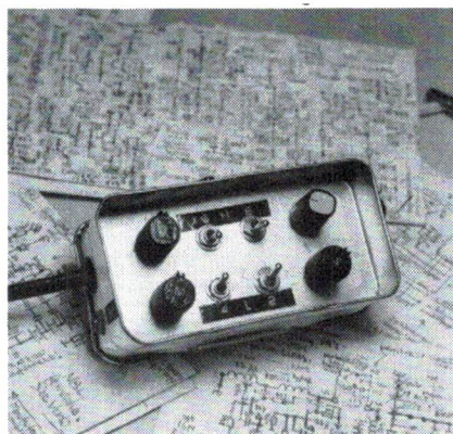
Een Varipad in jaszakformaat, opgebouwd uit twee blikdoosjes, rug aan rug. Het frontdeksel kan evt. dienen als 'freq. lock'.
