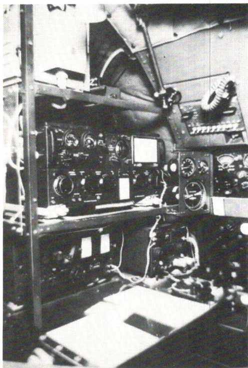
De DC-3 radioshack met ART13 AMLCW zender en BC348 ontvanger.
