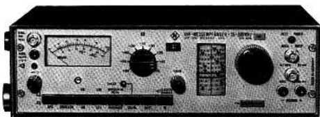
Figuur 1. VHF-veldsterktemeter HFV van Rohde & Schwarz; een wat ouder meetinstrument, 'slechts' geschikt voor 25-300 MHz. Continue afstembaar en analoog. Wel leuk voor S-meter vergelijking!
