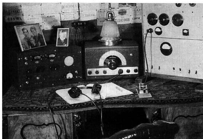
Afb. 9 Foto uit 1949. Geheel rechts de zender en in het midden een ontvanger van Australisch fabrikaat, de AWA.
