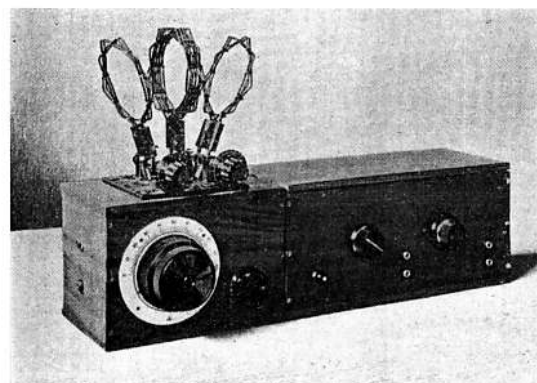
Afb. 1 De AVRO ultra korte golf ontvanger. 1-lamps ontvanger, uitgebreid met 2-lamps versterker met de Philips A415 en B405.
