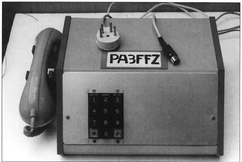
Met deze kast tussen de telefoonlijn en de zender wordt bij PA3FFZ gerelayeerd.
