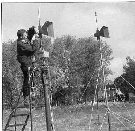
Jan, PA3FEX, plaatst de 'standaard-gain' hoorns voor de kalibratie van de meetbaan en de instrumenten.
