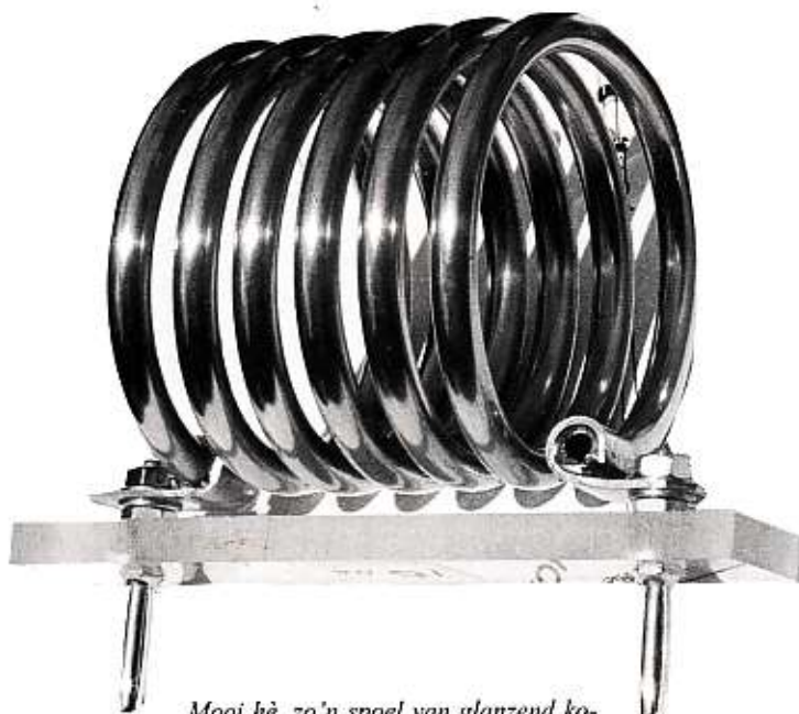
Mooi hè, zo'n spoel van glanzend koper op een onderplaat van perspex... de afmetingen van het perspex zijn: 110x20x6mm. De stekerpennen zijn gelijk aan die die voor het ingangsfILTER gebruikt zijn en de afstand tussen de pennen bedraagt 80mm.
