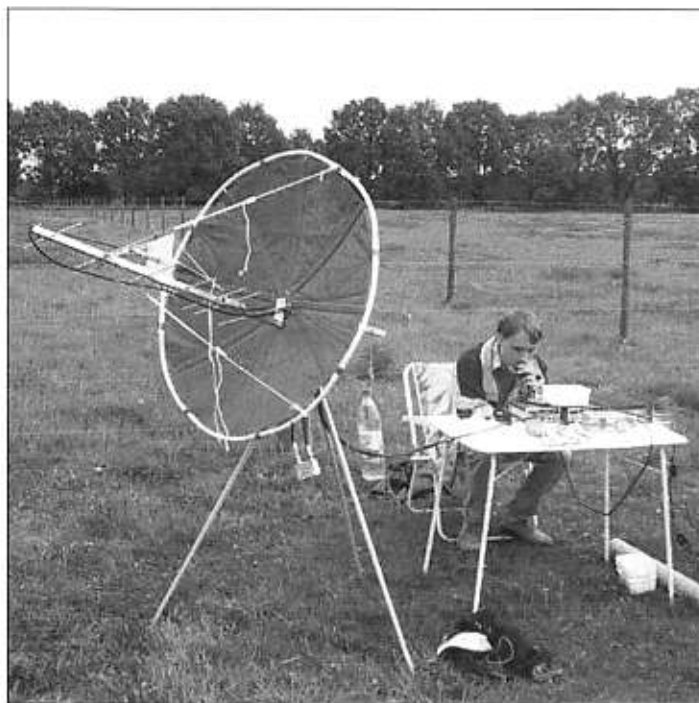
Foto boven: Op de voorgrond de opvouwbare schotelantenne die in de praktijk wordt gebruikt voor het downloaden van de 13cm-signalen van AO-40. Op de achtergrond de opblaasbare schotel.
