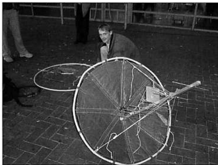
Foto boven: Op de voorgrond de opvouwbare schotelantenne die in de praktijk wordt gebruikt voor het downloaden van de 13cm-signalen van AO-40. Op de achtergrond de opblaasbare schotel.
