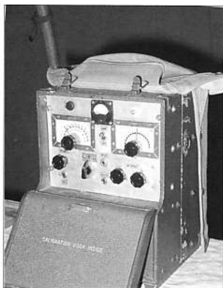
De door PAoIF ontworpen zender voor het noodnet, gehuisvest in een kast van de beroemde frequentiemeter BC221.
