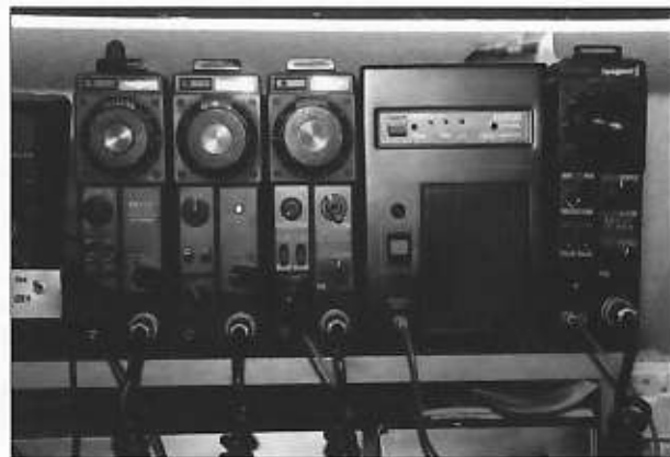
De QRP-transceivers van Robert, PA9RZ (JO22gf). Het zijn de IC 502 voor 6m SSB/CW; de IC 215 voor 2m FM; de IC 202 voor 2m SSB/CW en de IC 402 voor 70cm SSB/CW. Alles met een output van ca. 3 watt.
