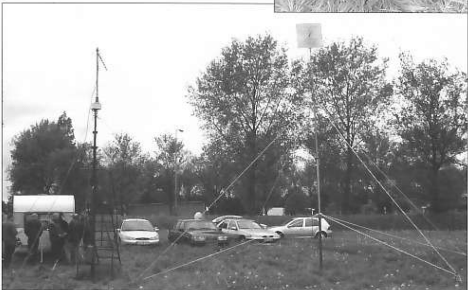
Het meten van de voor/achter verhouding op 70cm met de achterkant van de antenne naar de zender gericht.
