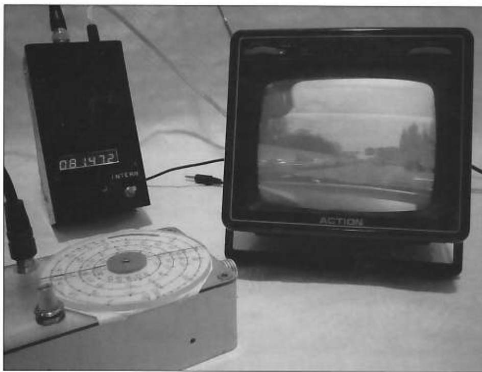
Meetopstelling met de TV als referentie met atoomkloknaauwkeurigheid. Het kristal in de counter kan omgeschakeld worden tussen een externe standaard zoals een TV en het inwendige kristal als de nauwkeurigheid niet zo belangrijk is. Gemeten wordt hier de frequentie van een dipper zoals gepubliceerd in het blad RAM.
