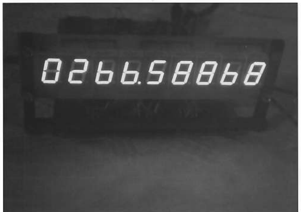
Het kan, 266MHz meten met een resolutie van 10Hz. Een goede standaard is noodzakelijk en een lange meettijd.
