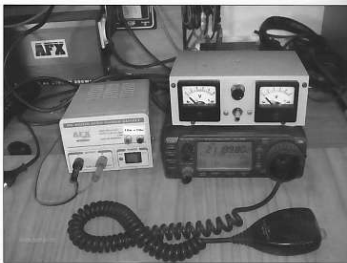
Foto 16 De opstelling in de Camper, links de 12 V voeding (overdreven groot hi). Boven de IC706 het bedieningskastje.
