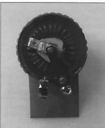
Foto 7 Klaar, de wikkelingen zijn nog net zichtbaar, dagje laten staan. Daarna de windingen 0,5 afvrijlen (draaien is beter), zodat het blanke koper zichtbaar wordt.
