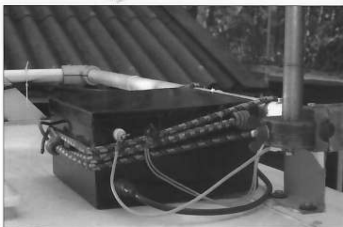
Foto 18 De reisopstelling, e.e.a. waterdicht gemaakt. De coaxplug aftape met zelf vulkaniserende tape. De "zwarte" vleugelmoer is de aarde en zit permanent vast aan het aluminium dak van de camper. Aan de keramische plug kan zowel de voet van de zichtbare spriet geschroefd worden als wel een langdraad antenne, die ergens met een klein gewichtje d'r aan in de bomen gezwiept is!! De montage van de gehele unit is zeer professioneel uitgevoerd met een paar snelbinders (Halfords zoals u wilt).
