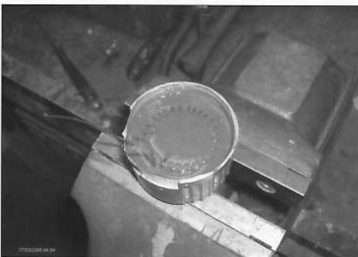
Foto 7 Klaar, de wikkelingen zijn nog net zichtbaar, dagje laten staan. Daarna de windingen 0,5 afvrijlen (draaien is beter), zodat het blanke koper zichtbaar wordt.
