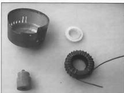
Foto 3 Verwijder alle metalen rompslomp aan de binnenkant.
