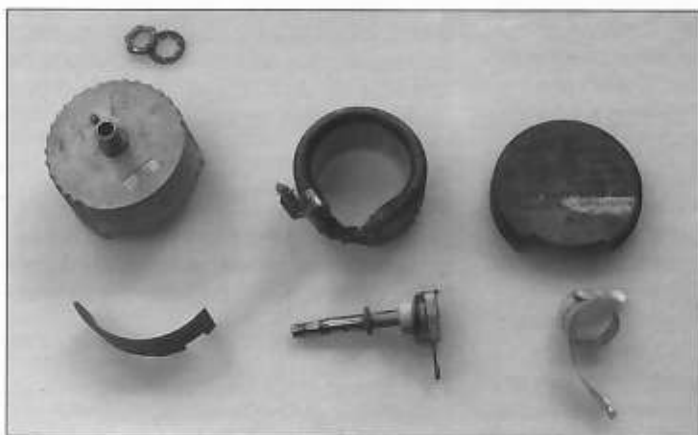
Foto 2 Zoek een oude draadgewonden potmeter behuizing en sloop die.
