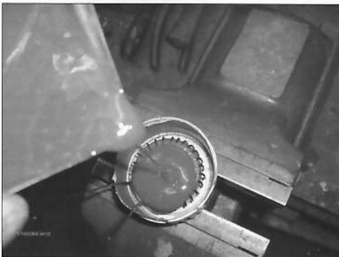
Foto 6 Ingieten met 2 componenten epoxyhars, Araldite of zoiets.
