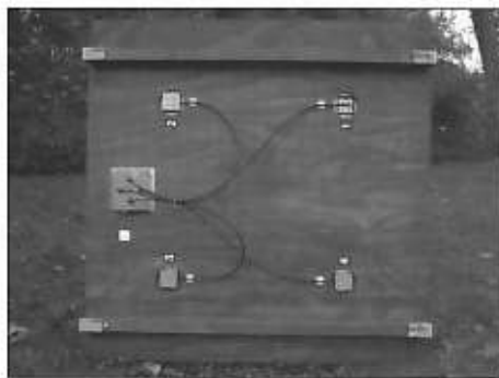
De antenne grondplaat aan de onderkant. De afmetingen zijn 1x1 meter. Houd alle coaxkabels naar de RF-combiner op gelijke lengte. Antenne 1 komt aan de voorkant van de auto boven de bestuurdersplaats.
