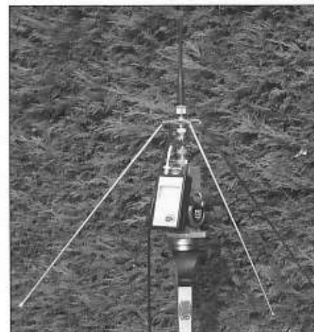
Foto 4. Meten van de staande golf verhouding van een rubber duck portofoon antenne.
