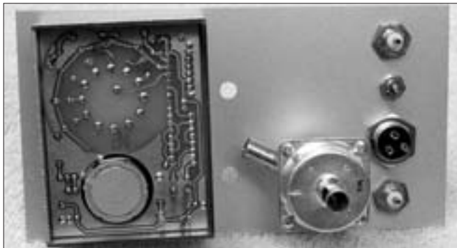
De HF-generator, gemonteerd vanaf achterzijde gezien.
