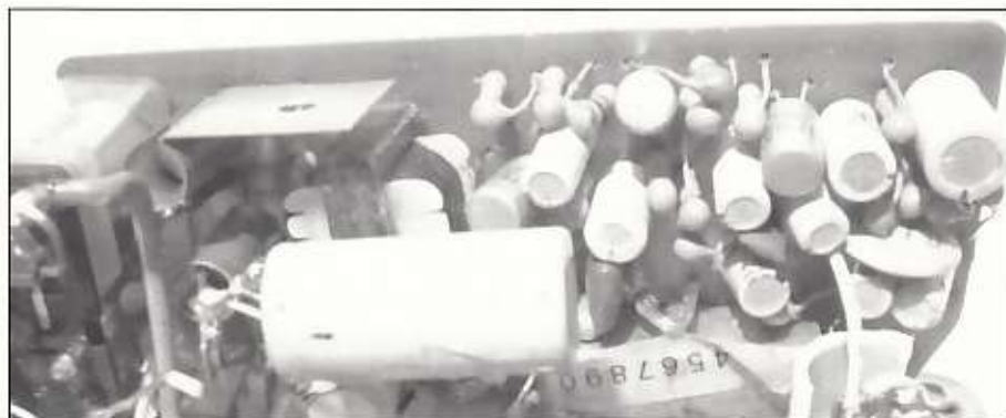
Een compleet printje met daarop rechts de microfoonversterker inclusief de compressor en links de audio-eindversterker, alles nog in ouderwetse germaniumtechniek. Het geheel is onderdeel van een experimenteel 80-meter AM-zendertje waarbij de eindversterker met de transformator koppeling gebruikt wordt voor het moduleren van de draaggolf.
