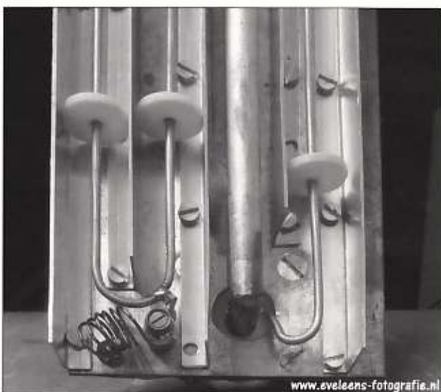
De switch, gezien vanaf de zijde van de TX-connector.
