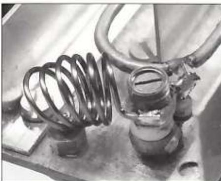
Detail opname van de RX-lijn met de extra geplaatste diode.
