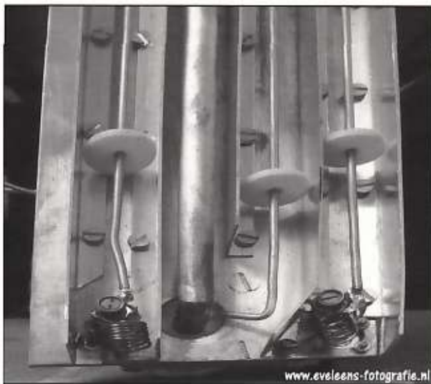
De switch met in het midden de doorvoer naar antenneconnector en rechts die naar de RX-connector.
