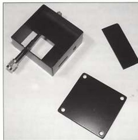
Foto 3: Behuizing klaar voor inbouw van de brug.
