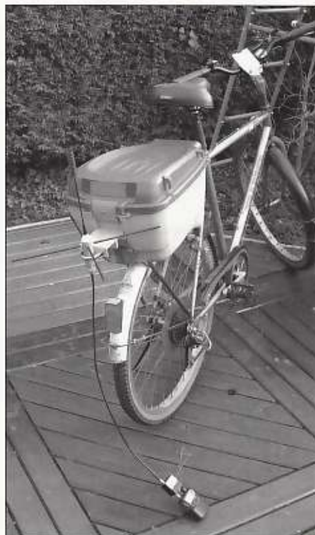
De SWR meter in actie bij het meten van de antenne achterop mijn fiets.
