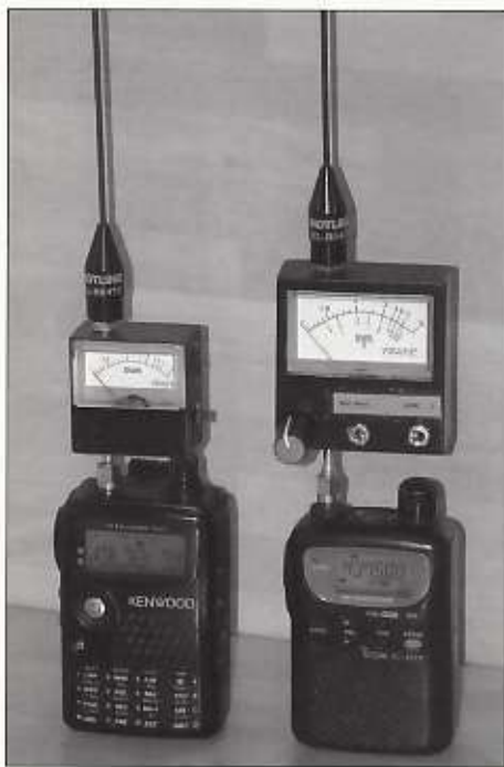
Foto 1: Een tweetal uitvoeringen van de staande SWR meter.
