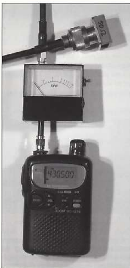
SWR Meter tijdens het testen, aangesloten op een 50Ω dummy-load.
