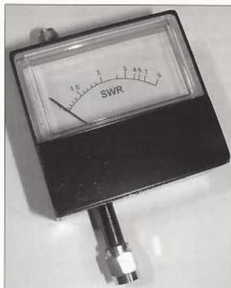
Foto 2: De afmetingen van de SWR meter zijn grotendeels afhankelijk van die van de draaispoel meter.
