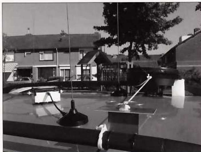
Doppler peiling en 13cm ontvangstantenne.
