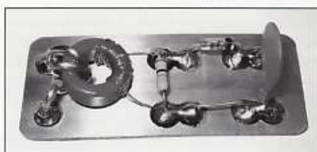
De stroomdetector print gereed voor montage in de behuizing.
