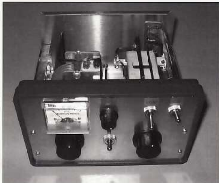
De voorzijde van de antennetuner.
