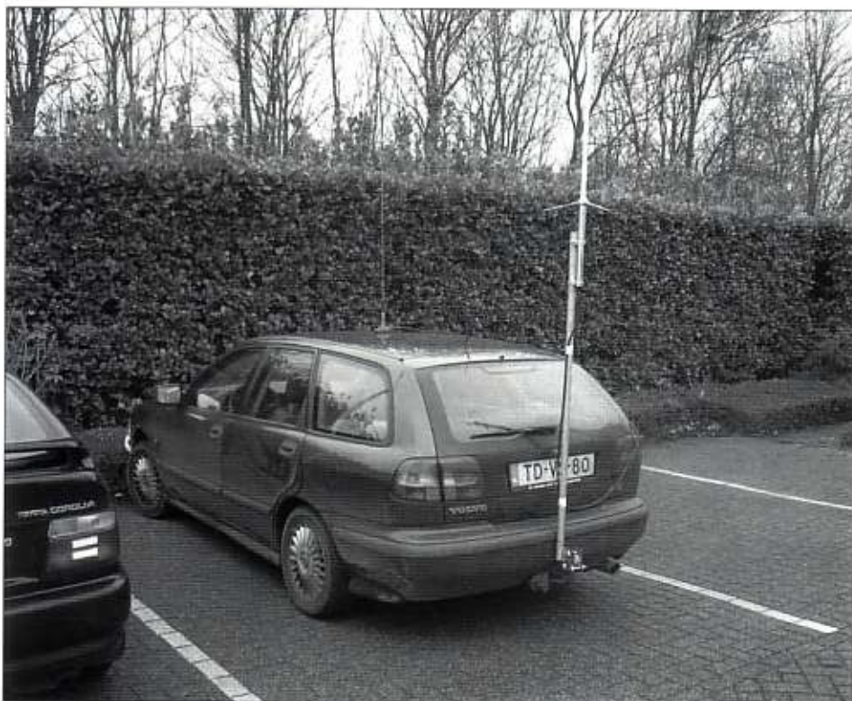
Operator op de achterbank: Rob Lichtendahl PA3DEW. Chauffeur voorin: Marian; XYL. Apparatuur: 145 MHz: Condor uitgangsvermogen 10 Watt naar kleevoet antenne; 432 MHz: Condor uitgangsvermogen 10 Watt naar Daimond X 30 trekhaak antenne.
