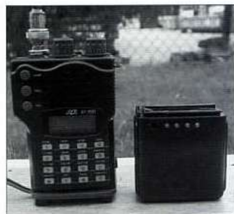
Foto 1. De meest linkse LED gaat het eerst uit als de batterijen een beetje leeg raken.
