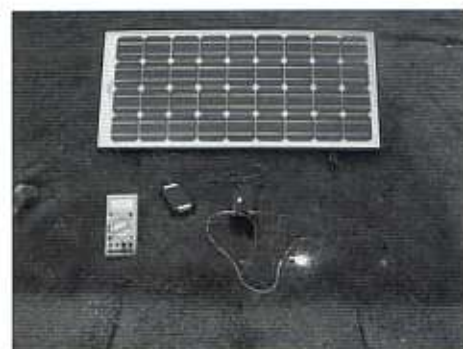
Foto 347. De spanningsbegrenzer in werking, met zonnepaneel, accu en voltmeter, nu met een lampje van 21 W, als belasting erbij.
