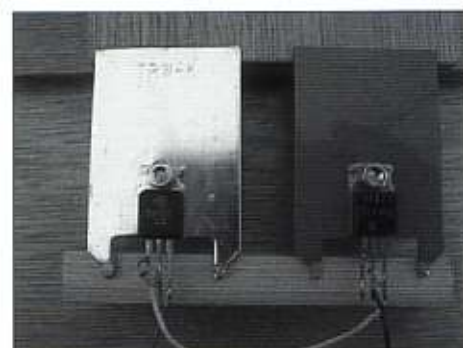
Foto 336. Gelakte en ongelakte koelplaatjes test.
