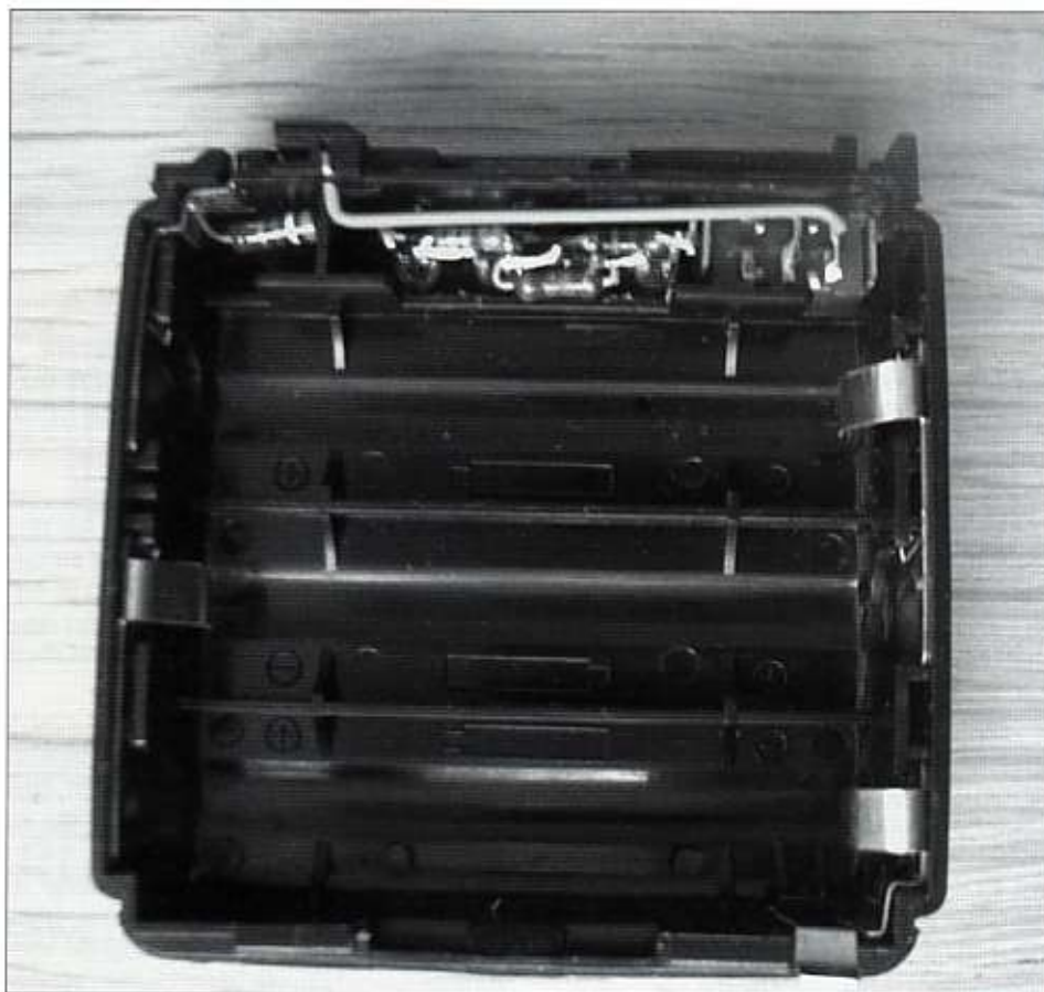
Foto 359. 4 LEDjes + weerstanden + schakelaar kun je soms nog in de kleinste hoekjes kwijt.
