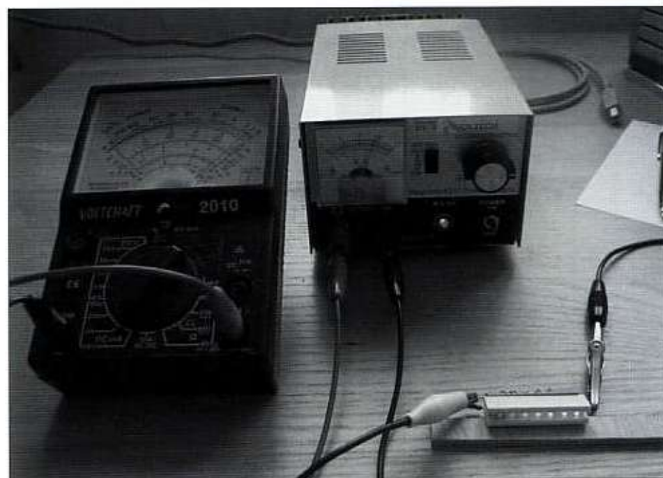
Foto 352. LED-reeks, zoals figuur 1a, met 14 V, 25 mA.
