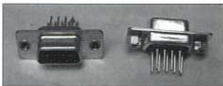
Figuur 2. De chassisdelen voor RS232.
