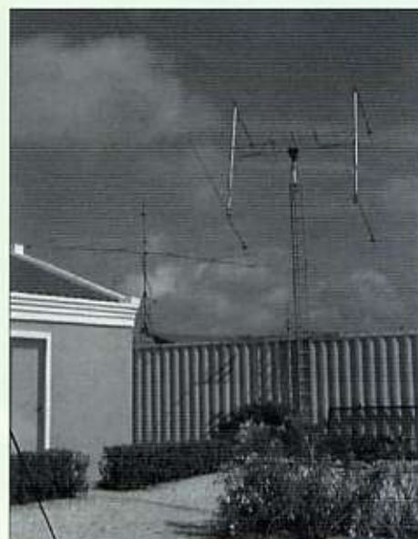
4 x 9 el. Wimo, gemonteerd tegen een 12 meter zeecontainer.
