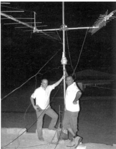
Yaser, 9K2YM, en Tomi, S53CO, onder de gebruikte 17 elements Yagi. In deze opstelling loopt de horizontale ligger nog door het stralingsveld van de antenne en dat is inmiddels aangepast.
