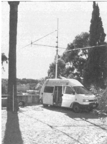
De mobiele shack van 1AoKM met op de pneumatische mast de 2 x 17 elements M2 antennes.
