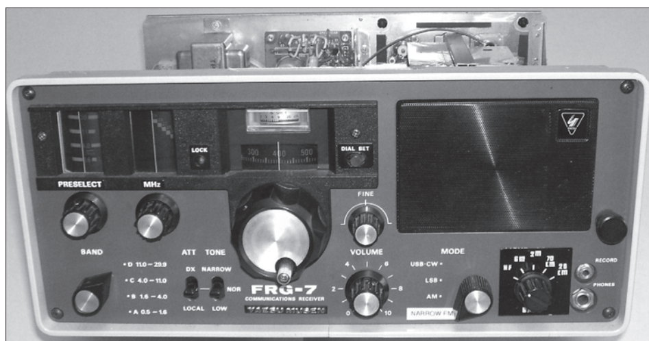
De omgebouwde FRG-7. Er is naar gestreefd om het oorspronkelijke uiterlijk zo min mogelijk aan te tasten. De volumepotmeter is voorzien van een schakelaar om de ontvanger aan en uit te zetten.
