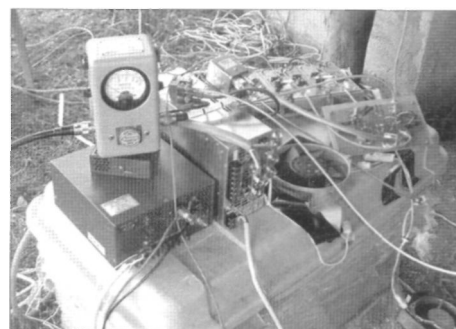
DXoEME beschikte over ongeveer 300 Watt uit een SSPA (solid state power amplifier).
