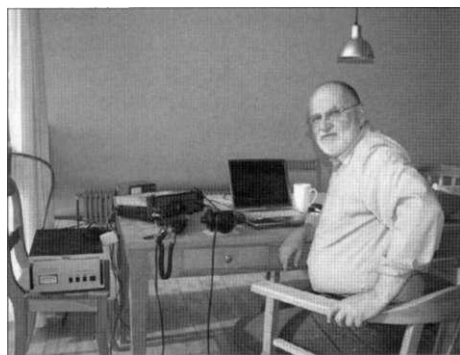
De tafel in het vakantiehuisje diende als shack. De Beko HLV-1500 eindtrap die links op de stoel staat heeft een geschakelde voeding en weegt slechts 17 kg. Ideaal dus voor op een expeditie.
