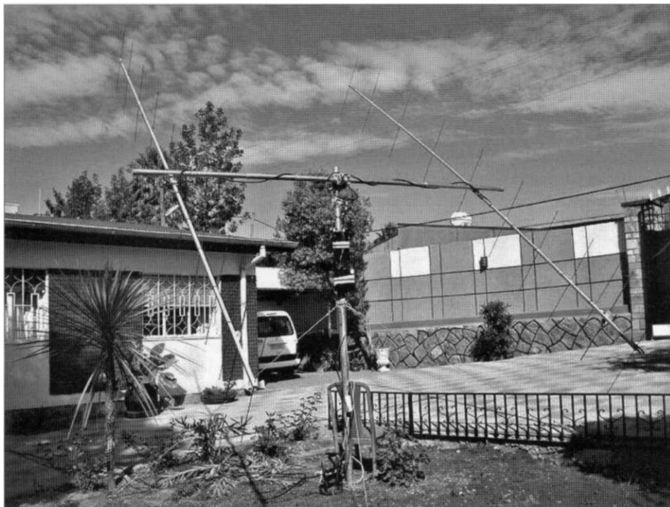
Twee vertikaal gepolariseerde 11 elements YU1EF antennes bij ET3AA. De SSPA zit vlak onder de antennes gemonteerd. De lage plaatsing van de antennes heeft geen nadelige invloed op de werking.
