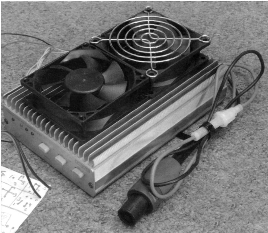
De ventilatoren kunnen gemonteerd worden op de koelplaat van de eindtrap.
