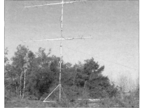
Jussi, OH6ZZ/0. 2 x 8 el Yagi's en een GS35 zorgden voor een prima signaal!
