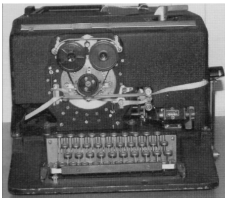
Tijdens de Tweede Wereldoorlog door de Amerikanen gebruikte codeermachine Sigaba. Door het complexe wieltransport was deze machine zeer veilig en is deze nooit door de Duitsers gekraakt.
