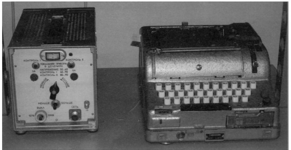
Russische codeermachine Fialka M-125. Omstreeks 1956 ontwikkeld en tot in de jaren 90 gebruikt door vrijwel alle landen van het Warschaupact. De machine heeft 10 codeerwielen die zeer onregelmatig worden bewogen. Het toestel is tevens voorzien van een ponsbandmaker, ponsbandlezer en een printer.
