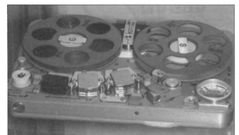
Miniatuur bandopnameapparaatje van Nagra, gevoed door twee penlight-batterijen. O.a. gebruikt door de Stasi voor het opnemen van gesprekken in hotelkamers waarvan men wist dat daar westerse diplomaten verbleven. Ook gebruikt in combinatie met een vulpenmicrofoon voor het opnemen van vertrouwelijke gesprekken.
