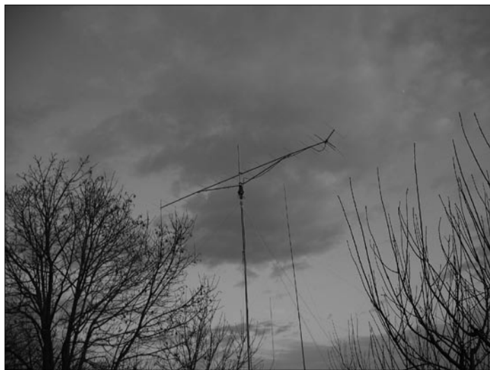
Oud maar nog steeds gebruikt: de 16 elements Tonna Yagi en hij voldeed prima bij IQ3AZ/P.
