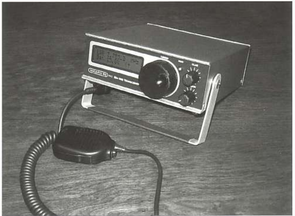
Foto 3. MKARS80 "Mark 2" met varicap-afstemming, LCD met achtergrondverlichting en een andere behuizing.
