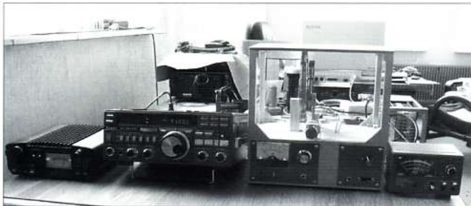
Duurttestopstelling van de rustige tuner met 100 Watt op 7,100 MHz uit de transceiver.
