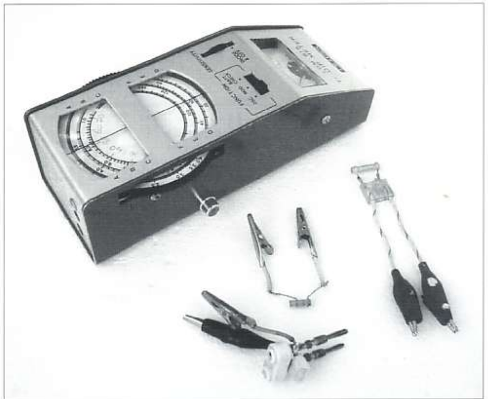
Met een paar eenvoudige hulpstukjes kunt u veel meer met de dipper. Twee condensatoren met een bekende waarde, 10pF en 50pF. Handig zijn twee stekerpennen met verschillende maten kristalvoetjes en krokodillebekjes om 'wat dan ook' op de dipper te kunnen aansluiten. Let op de 'tulip' connector in de zijkant van de dipper waarop een frequentieteller kan worden aangesloten.
