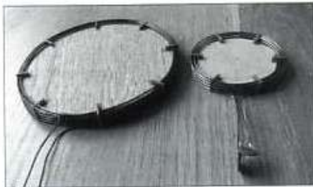
Grote en kleine spoel. De kleine is het moeilijkste te rijgen. Daar waar de windingen van gaatje moeten verspringen treedt veel wrijving op.
