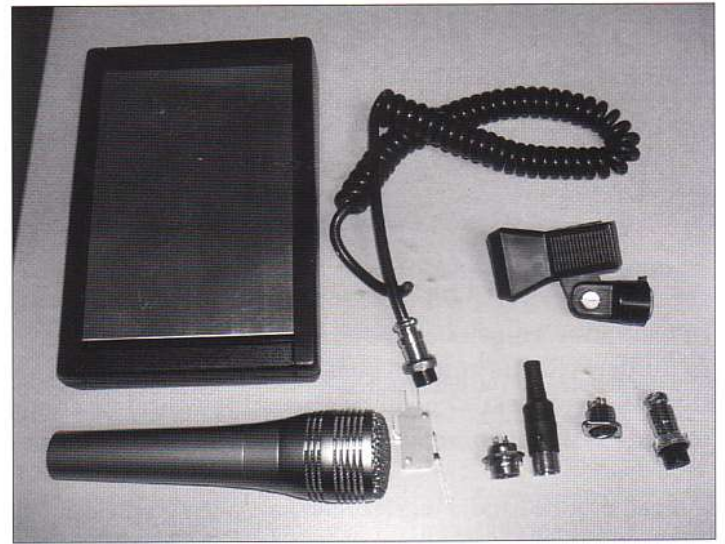
De benodigde onderdelen voor een zelfbouw microfoon.
