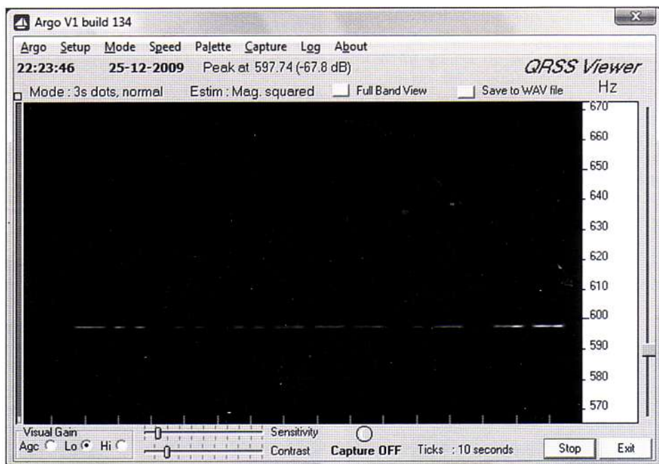
Het QRSS signaal van DI2AM. Het overseinen van de call duurt circa 2,5 minuut.
