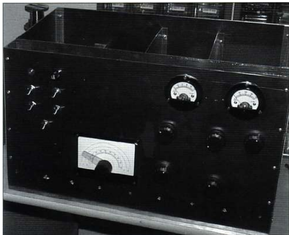
De kast van de drietraps zender in aanbouw.
