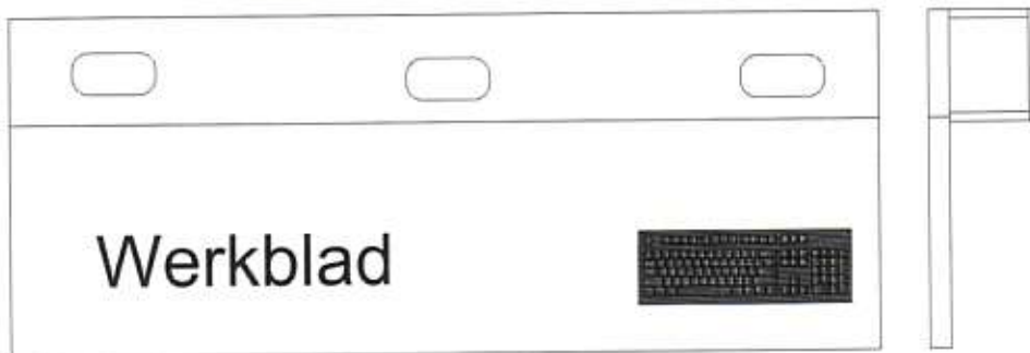
Een werkblad met aan de achterzijde een kabelgoot. Hierdoor kan de kabelchaos beperkt blijven. De kabelgoot is goed zichtbaar in het zijaanzicht.
