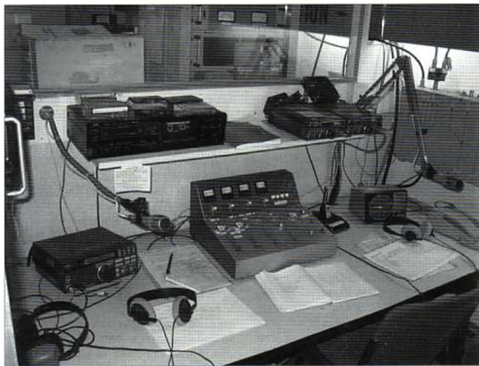
De voormalige shack van PI4VRZ/A in het gebouw van Achmea in Apeldoorn. Indien men meerdere transceivers vanuit verschillende bronnen van audio wil voorzien is het gebruik van een mengpaneel erg handig. Let ook op de eenvoud van de shack.
