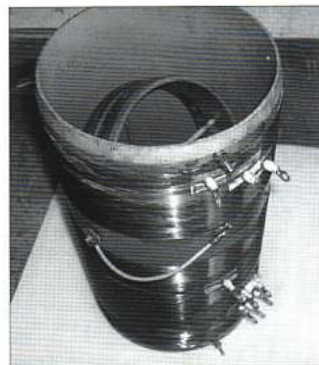
Deze variometer voor een 136 kHz antenne van PAoZH (CQ-PA 2005 nr. 10) toont aan, dat alleen een draadje trekken lang niet altijd voldoende is voor een goed afgestemde antenne.
