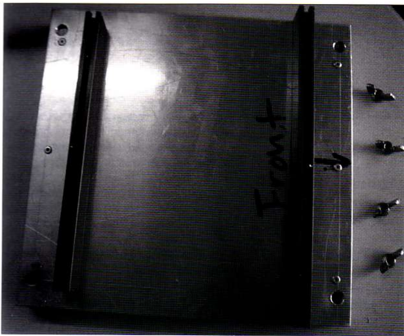
De verstevigde bovenzijde van het deksel, gereed voor plaatsing.
