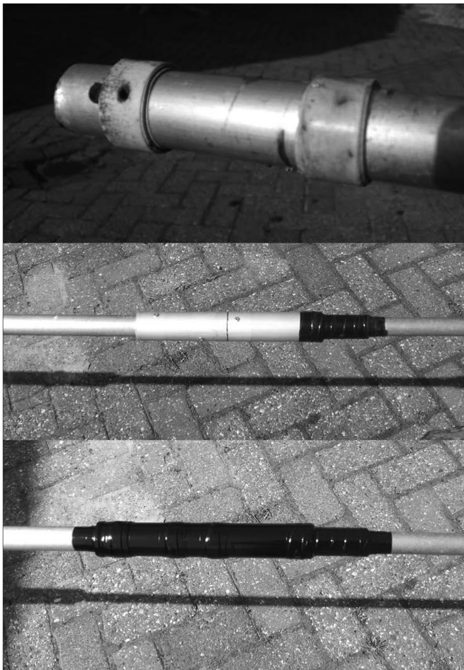
Foto 3, 4 en 5: van boven naar beneden de verschillende fasen van opbouw van de verlenging van de groundradialen.
