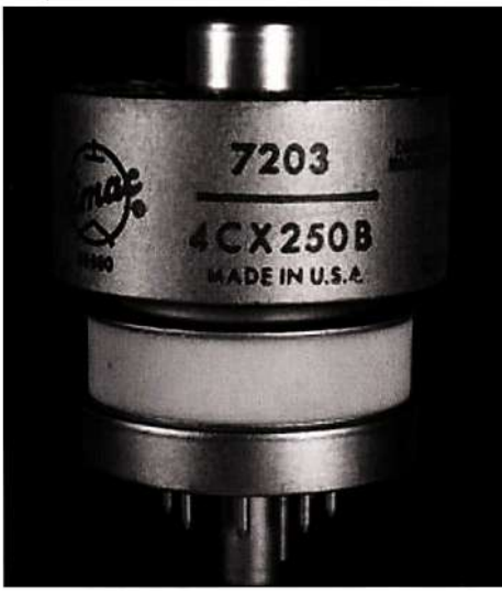
De 4CX250B, die in veel VHF linears is gebruikt.
