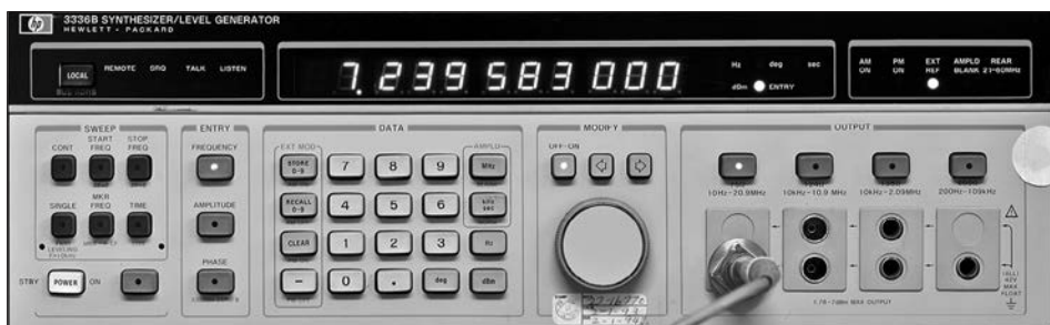
Foto 6: De HP 3336B Synthesizer/Level Generator voor het meten aan standards die geen 10 MHz signaal geven.
