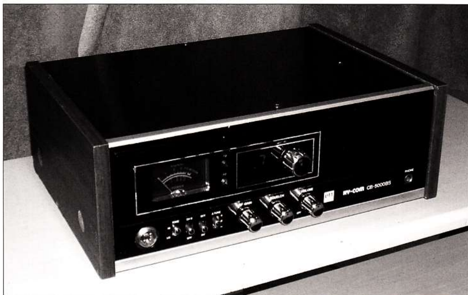
De Hycom 22 kanalen 0,5 watt in originele (gerestaureerde) uitvoering.
