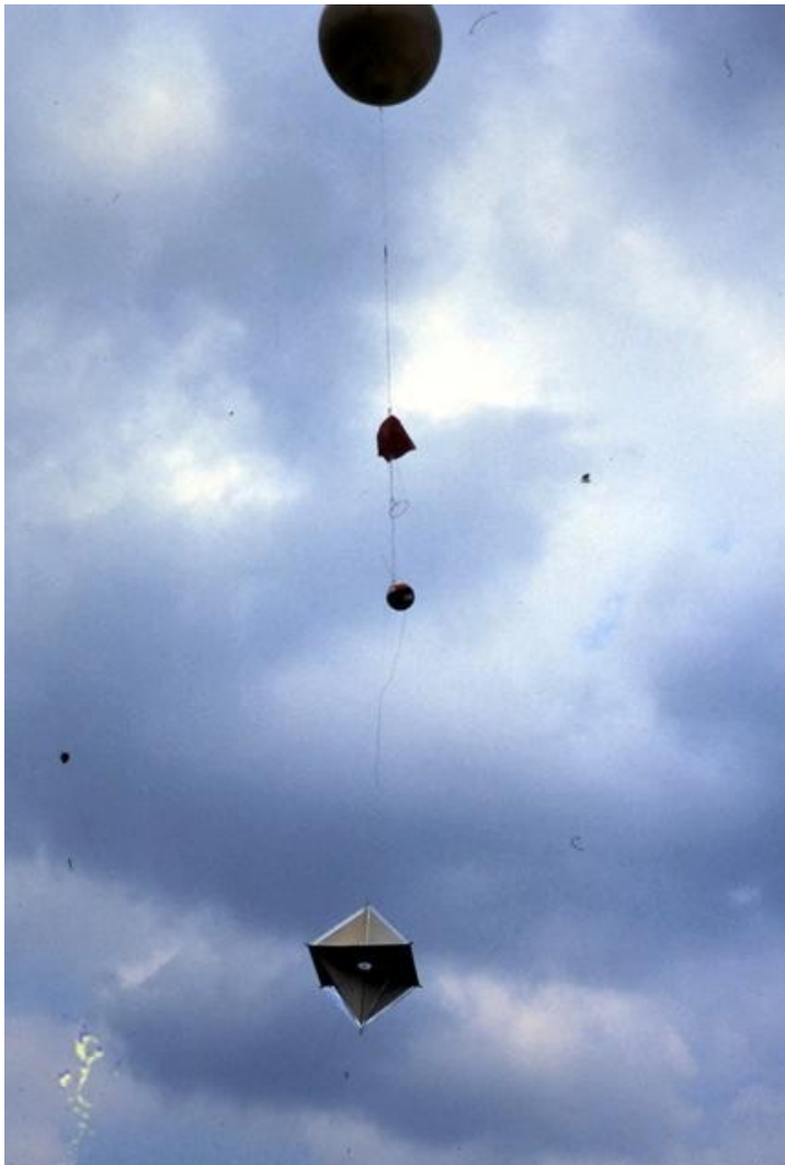
afb.9 En daar gaat de hele trein, Onder de ballon het ontkoppelmechanisme, daaronder de parachute, dan de zender en als onderste de radarreflector.
